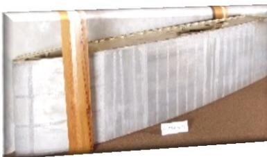
In der Mitte des Raumes ist ein Flügelteil der Latécoère 631 „Lionel de Marmier“ ausgestellt. Dieses Teil entspricht dem roten Strich auf dem Kartellfoto. Ungefähr 15 solcher Flügelteile bilden den Gesamtflügel, der eine Spannweite von 57m beträgt. Im Innern des Flügels befindet sich eine Art Tunnel, die es den Mechanikern ermöglichte, sich darin fortzubewegen, um im Falle eines Motorschadens während des Fluges, diesen beheben zu können.
