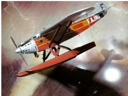
Pierre-Georges Latécoère hatte mit dem Bau der Wasserflugzeugteile der *Latécoère 300 Croix du Sud* begonnen, aber die Herstellung hatte sich verspätet. Daraufhin entschied er ein Landflugzeug Latécoère 28 in ein Wasserflugzeug **Latécoère 28.3 Le Comte de la Vaulx** umzubauen, indem er es mit Schwimmern ausstattete.
